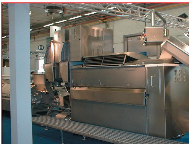
**FILATRICE A COCLEA ORIZZONTALE ALMAC**, con sistema di salatura elettronico alimentata a coclea riscaldata. (foto Simo 2003)
